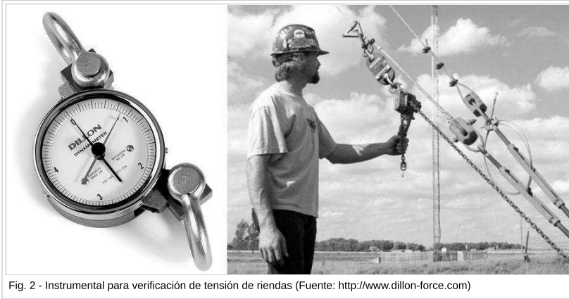
Fig. 2 - Instrumental para verificación de tensión de riendas (Fuente: http://www.dillon-force.com )
