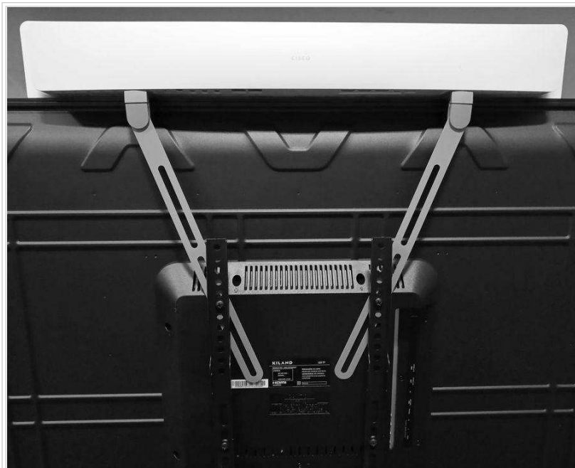
Fig. 3 : Roomkit instalado en TV VESA 200 x 200 mm
