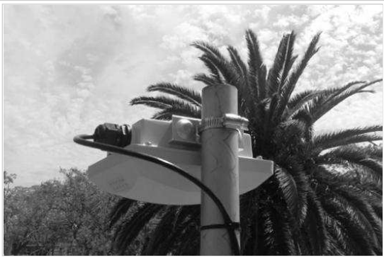
Fig. 1 - Equipo Ruckus T300 fijado a caño
