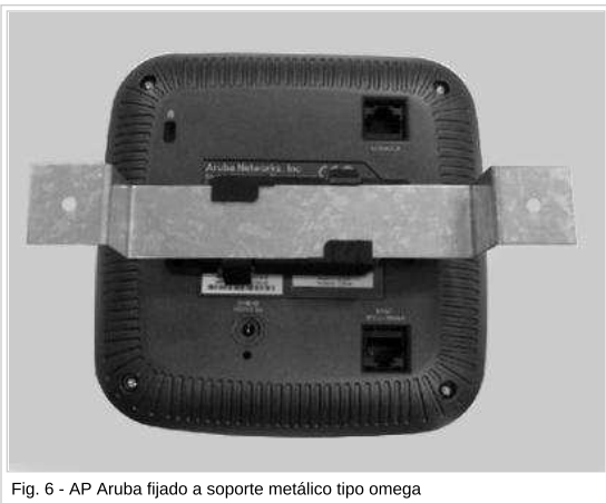
Fig. 6 - AP Aruba fijado a soporte metálico tipo omega
