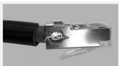
Fig. 4 Terminación de ficha blindada - FTP
