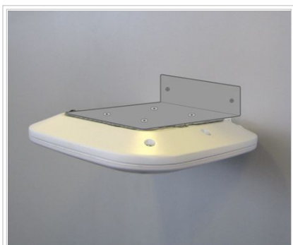
Fig. 8 - AP fijado a pared
