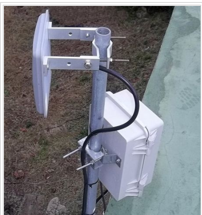
Fig. 1 - Mikrotik fijado a caño
