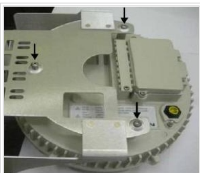
Fig. 2 - Separación del equipo de su base
