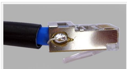
Fig. 2 Terminación de ficha blindada - FTP
