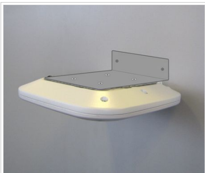
Fig. 8 - AP fijado a pared
