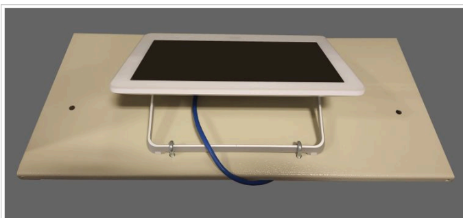
Fig. 4 : Fijación de panel táctil al estante
