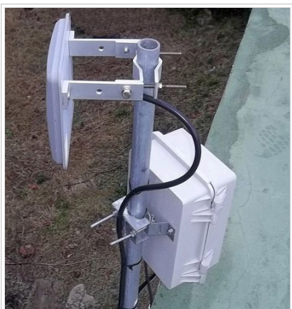
Fig. 1 - Mikrotik fijado a caño
