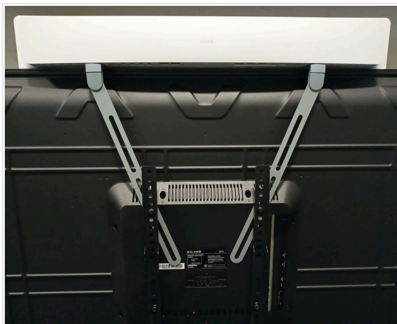
Fig. 3 : Roomkit instalado en TV VESA 200 x 200 mm
