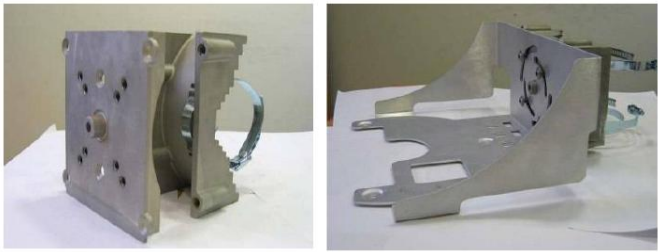
Fig. 3 - Preparación del soporte para caño
